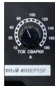
Плавная регулировка тока сварки
