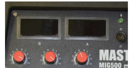
Цифровые индикаторы (амперметр и вольтметр)
