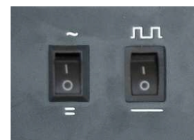
Переключатели DC/AC режимов и импульсного режима
