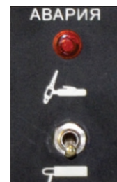
Переключатель MMA/TIG сварки
